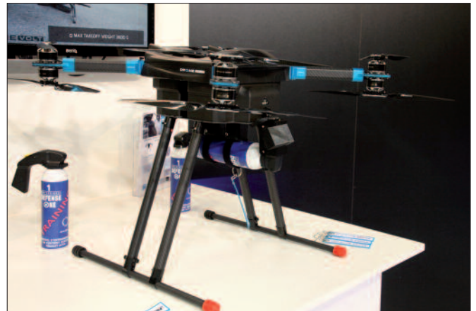
Drohne mit Tränengas-Kartusche.
