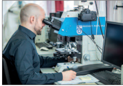
Fasern werden unter dem Hochleistungsmikroskop bei etwa 400-facher Vergrößerung angesehen.
