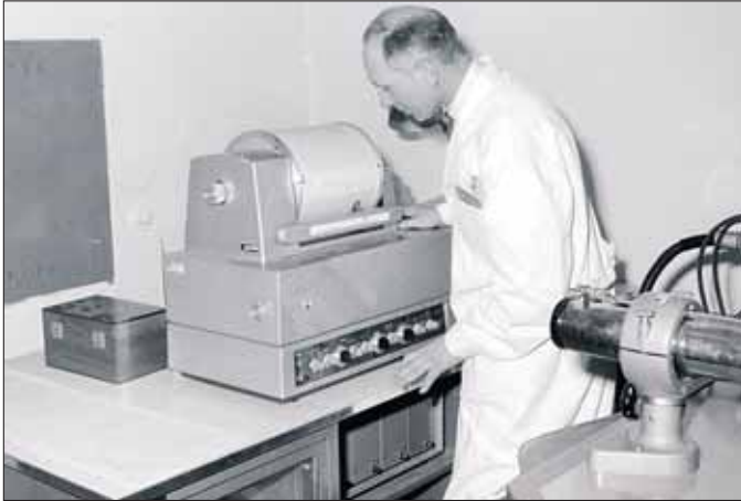
Mitte der 60er-Jahre „High-End-Technik“: IR-Spektrometer zur Identifizierung von organischen Stoffen.
