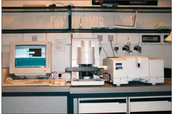
„High-End“ 2007: Mikro-IR-Spektrometer zur Untersuchung kleinster Proben, z. B. Lacksplitter, kleiner als 0,05 mm.
