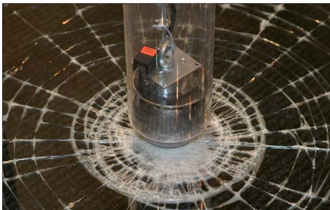
Mit Profilon-Sicherheitsfolie beschichtetes Glas zersplittert zwar, aber es bricht nicht.
