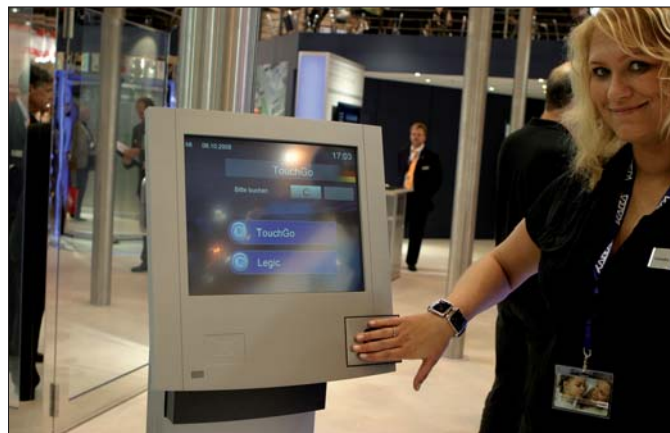
„Touch-Go“-System: Es genügt, den „Tag“ eingesteckt zu haben und die Leseinheit mit der Hand zu berühren.
