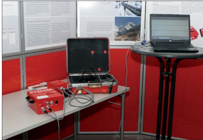
Messgerät zur Überwachung von Bauwerkserschütterungen und Sprengungen.
