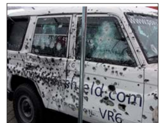
Beschusstest: Sicherheitsglas von Sonderschutzfahrzeugen.
