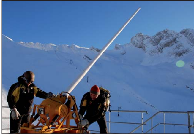
Lawinensprengergerät Avalancheur: Mit dem Geschütz kann eine Sprengladung von 2,2 Kilogramm bis zu 2 Kilometer weit verschossen werden.
