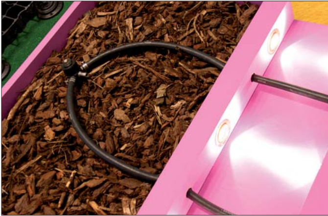
Unterflursystem: In den Boden verlegte Druckleitungen reagieren beim Betreten des Bodens.
