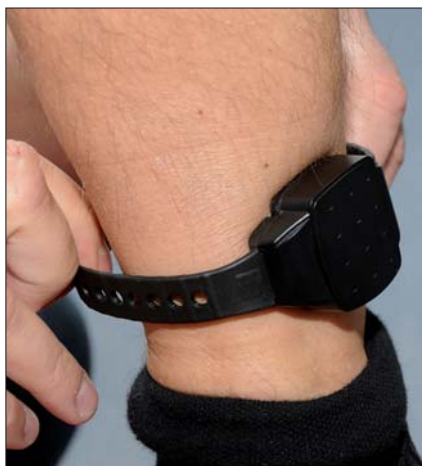
Die elektronische Fußfessel ist mittels „Radio Frequency“ mit der Basisstation verbunden.
