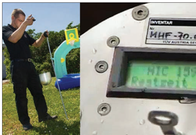
Spielgerät: Ein TÜV-Experte bestimmt mit einem TÜV-Prüfgerät den Schweregrad möglicher Kopfverletzungen.
