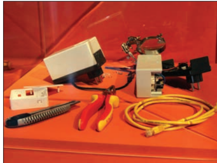
„Newstweek“: Bauteile zur Herstellung eines Gerätes zur Manipulation von Informationen über drahtlose Netzwerke.
