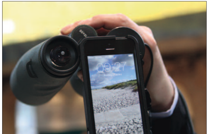
Fernglas-Adapter für iPhone: Mit dem Adapter kann über die Optik dieser Geräte fotografiert werden.
