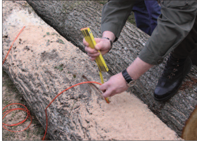
Vorbereitung zur Baumsprengung: Die Sprengschnur wird in Windungen in die Schlitzte eingelegt und dann verdammt.
