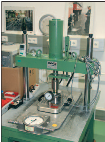
Überprüfung von Waagen zur polizeilichen Kontrolle von Schwer-Lkws.
