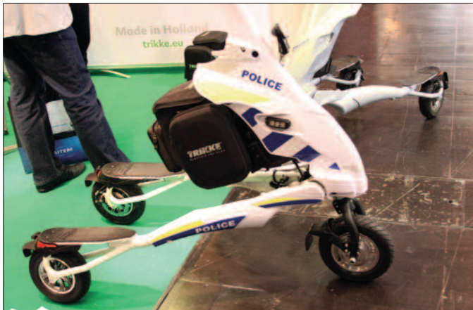
Zusammenklappbares Dreirad mit Elektromotor: Wird als Fortbewegungsmittel für die Polizei angeboten.
