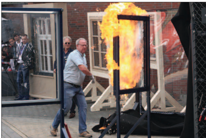
Glasscheiben mit Folien beschichtet: Leisten sogar noch einer Brandflasche Widerstand, dass kein Durchbruch erfolgt.
