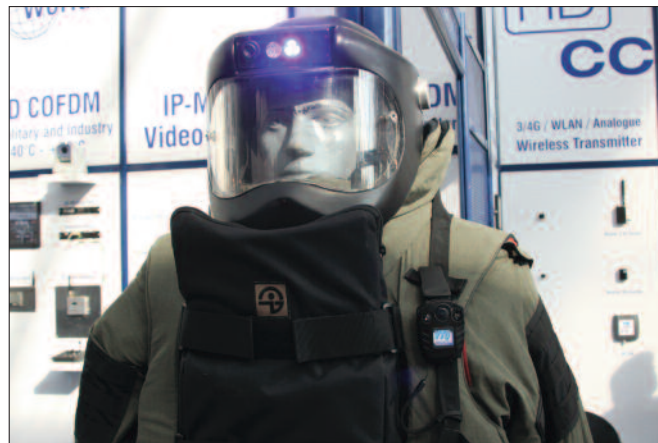
Videokamera für Sicherheitskräfte: Zeichnet während eines Einsatzes bis zu acht Stunden Video- und Audiosignale auf.
