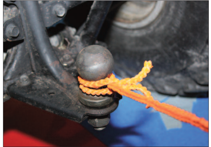
Schlaufenseil: Kann statt einer Verknotung um einen Gegenstand in eine der Schlaufen gesteckt und zugezogen werden.
