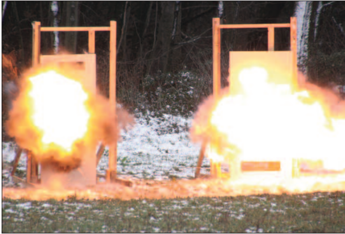
Aufsprengen von Türschlossern mit wenigen Dekagramm militärischen Sprengstoffs sowie mit kurzen Stücken Sprengschnur.
