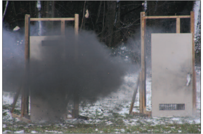
Aufsprengen von Türschlossern mit wenigen Dekagramm militärischen Sprengstoffs sowie mit kurzen Stücken Sprengschnur.
