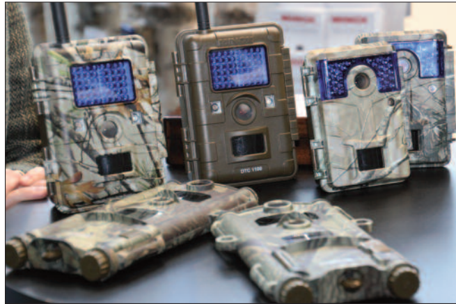
Wildkameras: Kameramodul kann vom Gehäuse getrennt und zur Auswertung entnommen werden.
