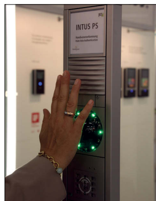
Handvenenscanner: Biometrische Identifizierung.
