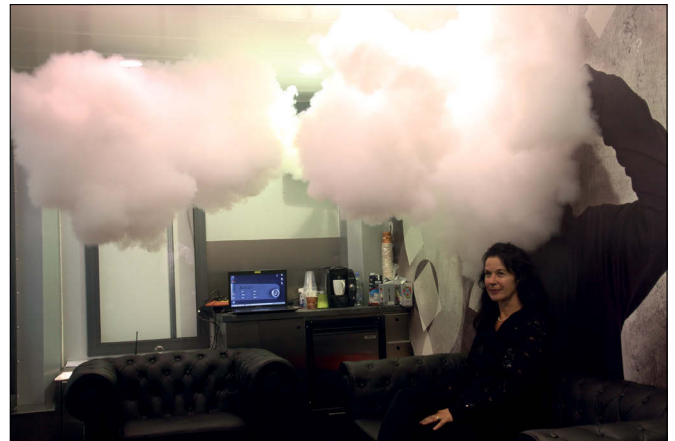
Bandit-Vernebelungsgerät zur Abschreckung von Einbrechern: Aktivierbar über Sensoren oder die Einbruchmeldeanlage.
