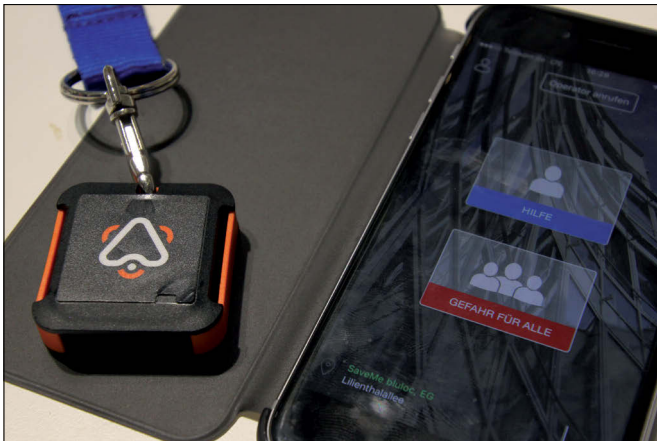
Notruf-App für Smartphones: Hilferufe oder Warnhinweise können mit einem Bluetooth-Taster versendet werden.
