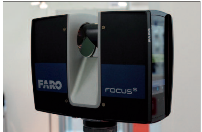
Laserscanner können auch für Unfallort- oder Tatortaufnahmen verwendet werden.
