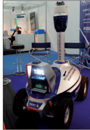
Outdoor-Roboter: autonome Überwachungsfahrten.
