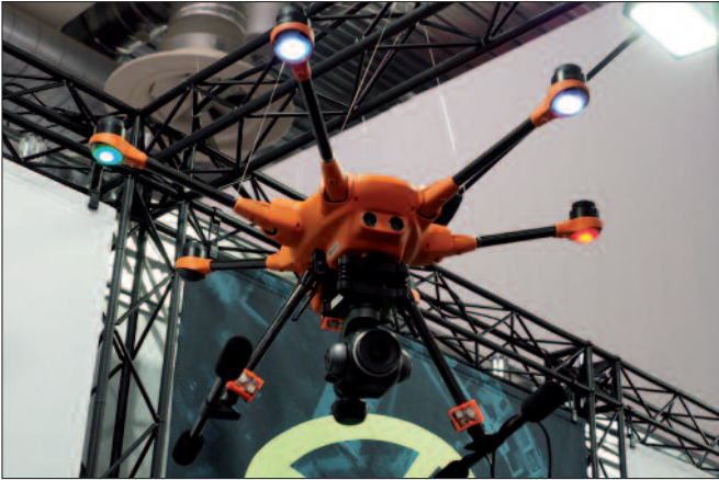
Kabelgebundene Drohne: Kann über die Bodenstation Geräte bis zu einer Leistung von 3 kW mit Strom versorgen.
