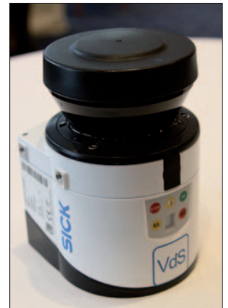
Laserscanner: Umfeld wird zweidimensional abgetastet.
