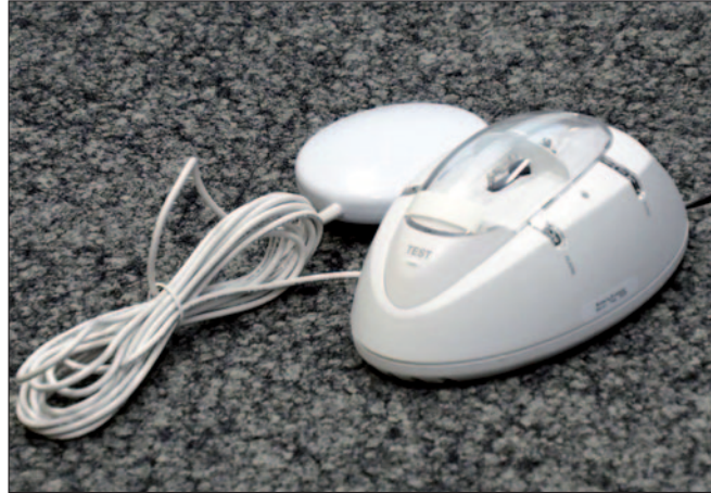
Optischer Rauchwarnmelder für Gehörlose: Vom Funk-Rauchmelder angesteuertes Blinklicht und eine springende Scheibe.
