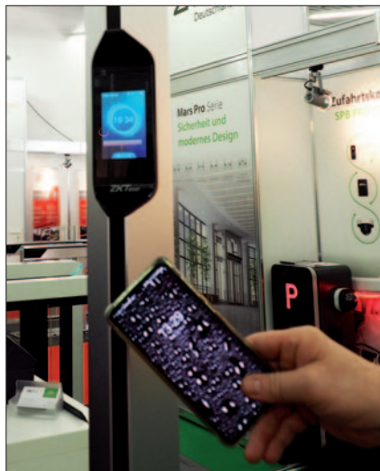
Smartphone-Detektor für Verbotszonen, wie Justizanstalten.
