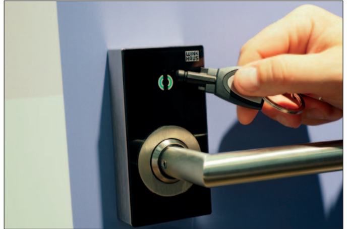
Überwachungslösung mit LIDAR-Technologie; Smart-Blue-System: elektronische Schließanlage für Unternehmen.
